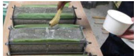
図3 含浸系補修材塗布状況
