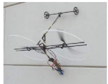
図3 壁面移動ロボット
