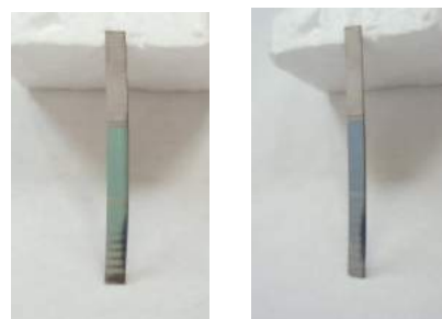
形状記憶基板を用いた干渉色薄膜材料。角度によって色が変わる。温度に
